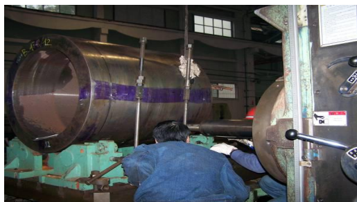
图3 汽水分离器筒身水平方向旋转图
