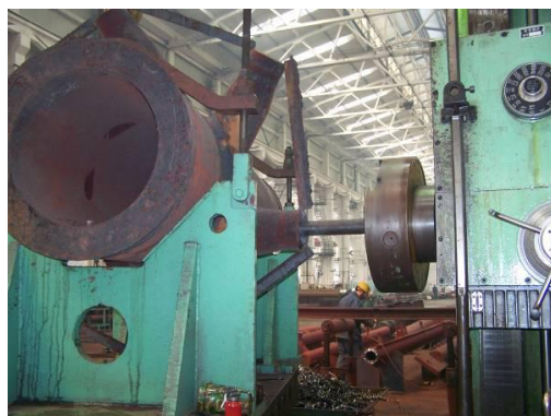
图8 刀片出现崩刃，修磨刀具后加工图
