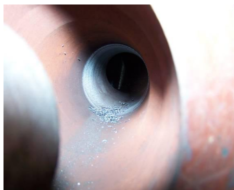
图9 高速钢刀具镗焊根加工完成图
