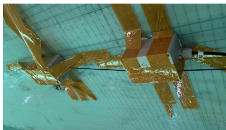
图5 光纤传感器技术示意图
