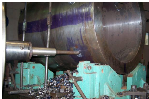
图4 采用接长刀杆加工孔图
