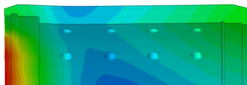
(b) 护环在启机时的变形
